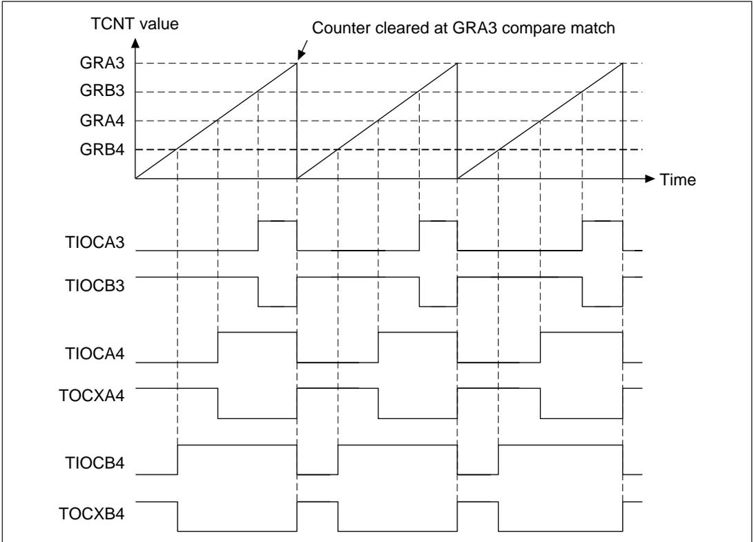
**Figure 10.32 Reset-Synchronized PWM Mode Operation Example 1**
