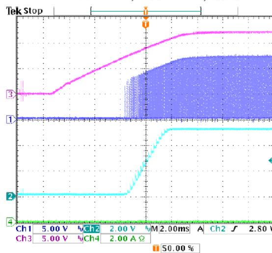
Ch1=SW , Ch2=V<sub>OUT</sub> , Ch3=V<sub>IN</sub> , Ch4=I<sub>OUT</sub>
