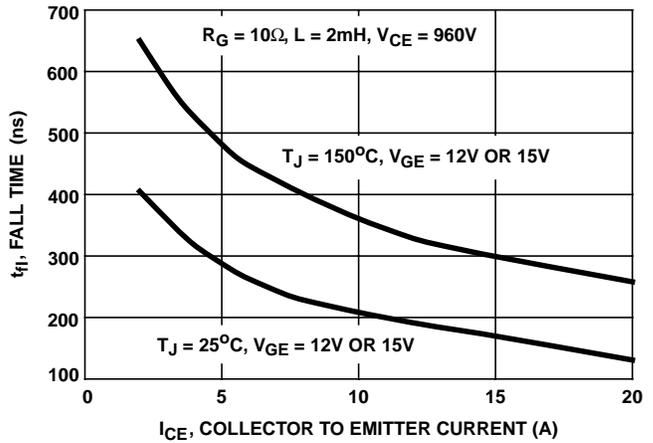
FIGURE 12. FALL vs COLLECTOR TO EMITTER CURRENT
