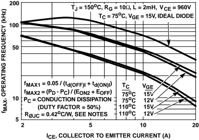
FIGURE 3. OPERATING FREQUENCY vs COLLECTOR TO EMITTER CURRENT
