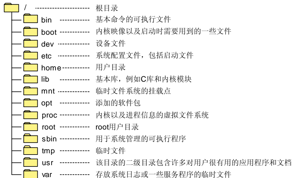
图4-1 根文件系统顶层目录结构图
