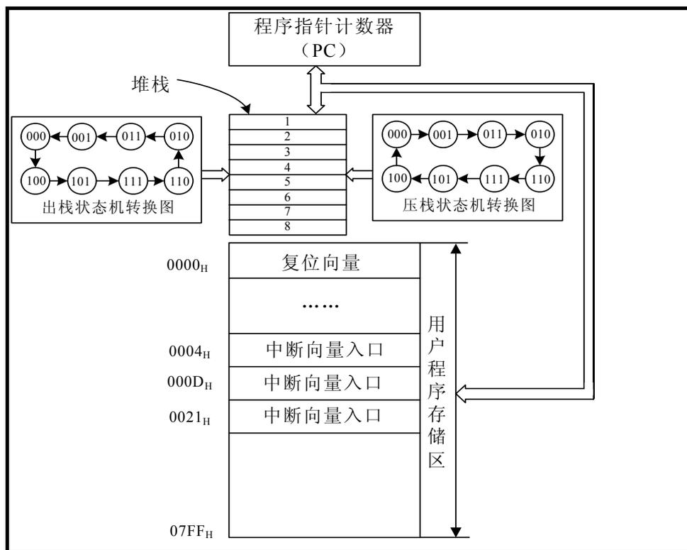
图 4.1 程序存储器映射和堆栈示意图
