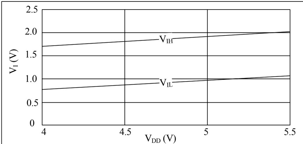
B: PB 端口输入特性 (室温 25°C)
