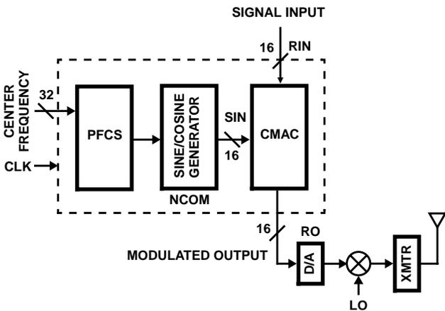
FIGURE 4. AMPLITUDE MODULATION
