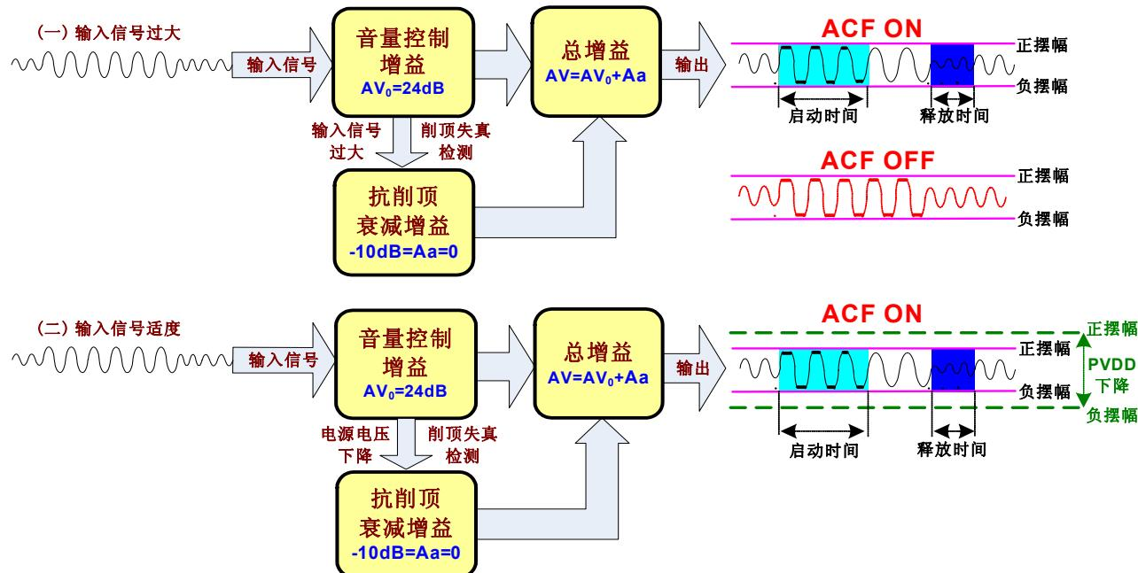
图5. 防削顶尖失真功能(ACF)的原理框图
