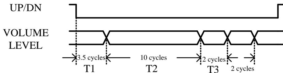
图1. 音量控制时序图
