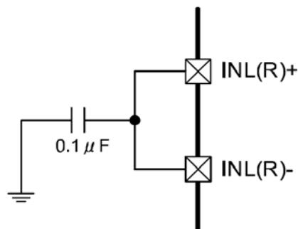
图4. 无用声道输入端的连接
