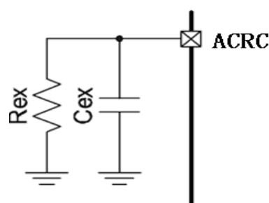
图6. ACF 模式引脚 ACRC 的外接方式
