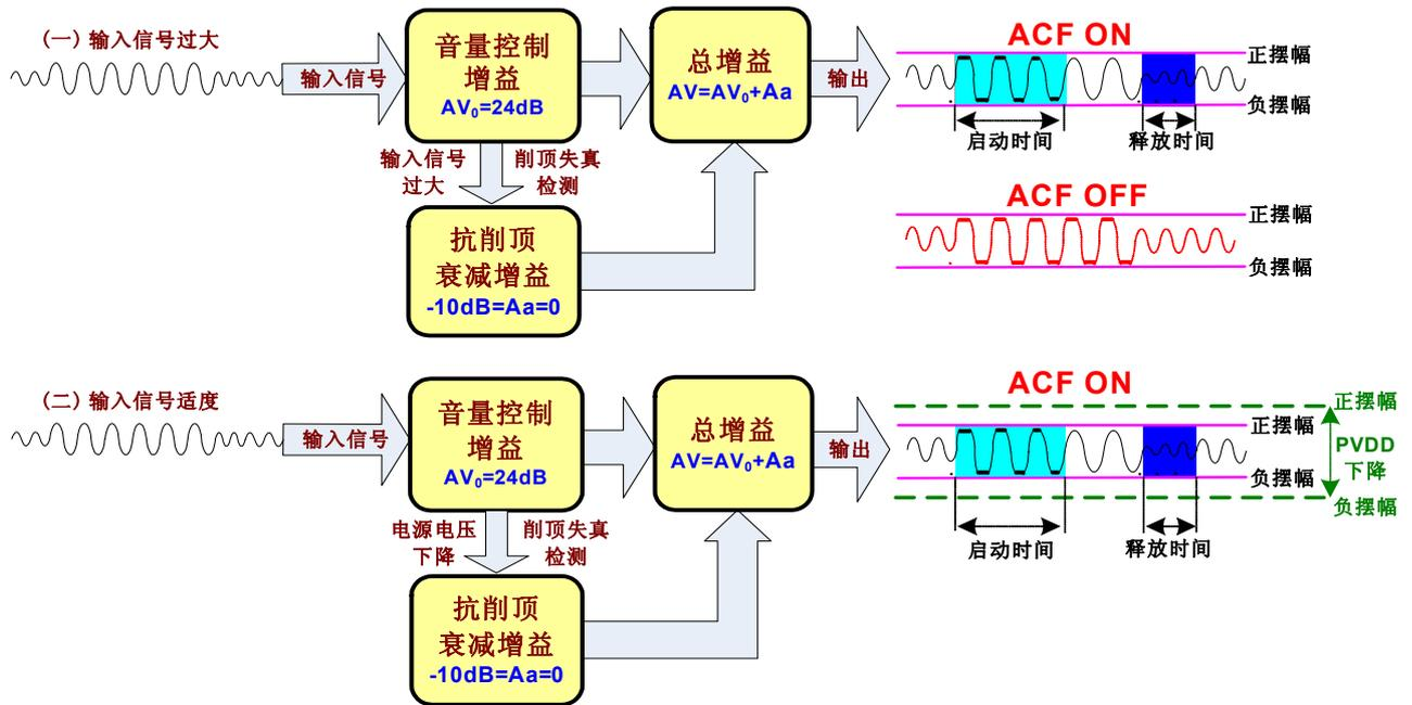
图5. 防削顶失真功能 (ACF) 的原理框图
