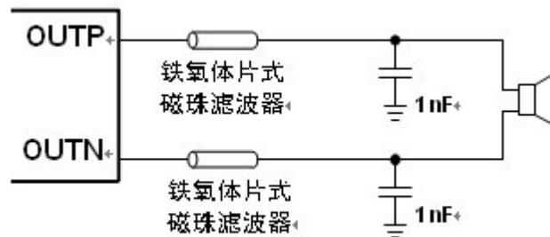
图4 典型的铁氧体磁珠滤波器
