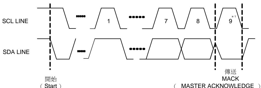
\* 1 MACK發生在連續讀取Multi bytes資料輸出時，當第二筆資料要輸出資料前，須在第9個CLOCK上升緣之前，由主控端(Master)控制SDA為輸出引腳，設定輸出為Low(ACK)，通知從機端(Slave)得以繼續輸出第二筆之後的資料。
