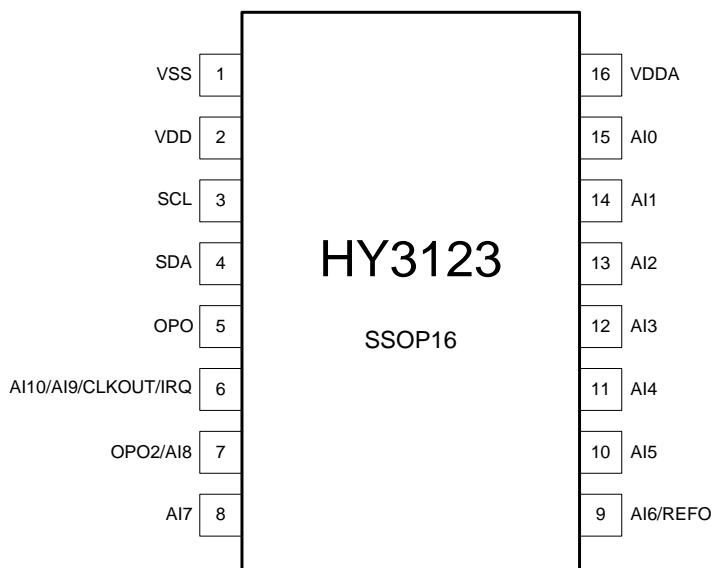
Figure 3-2 SSOP16 引腳圖
