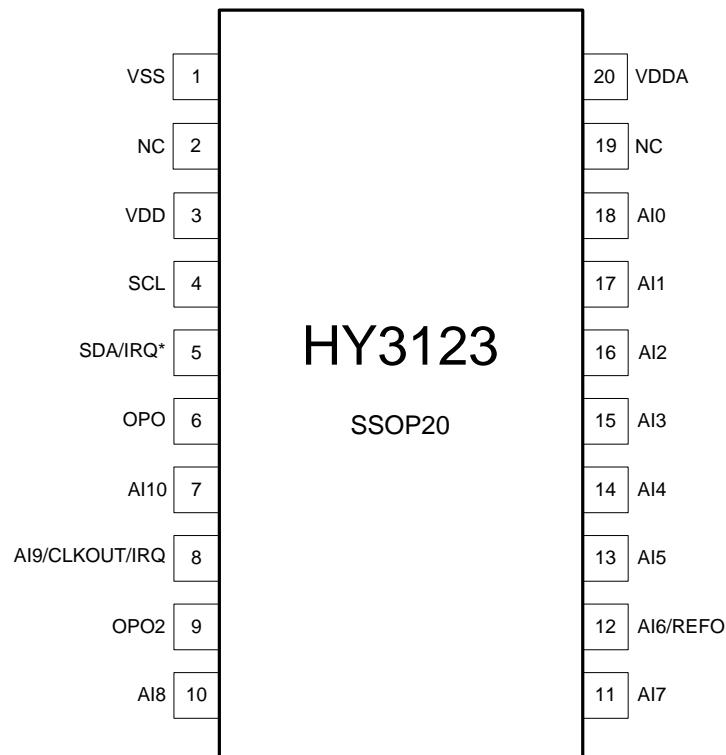
Figure 3-1 SSOP20 引腳圖
