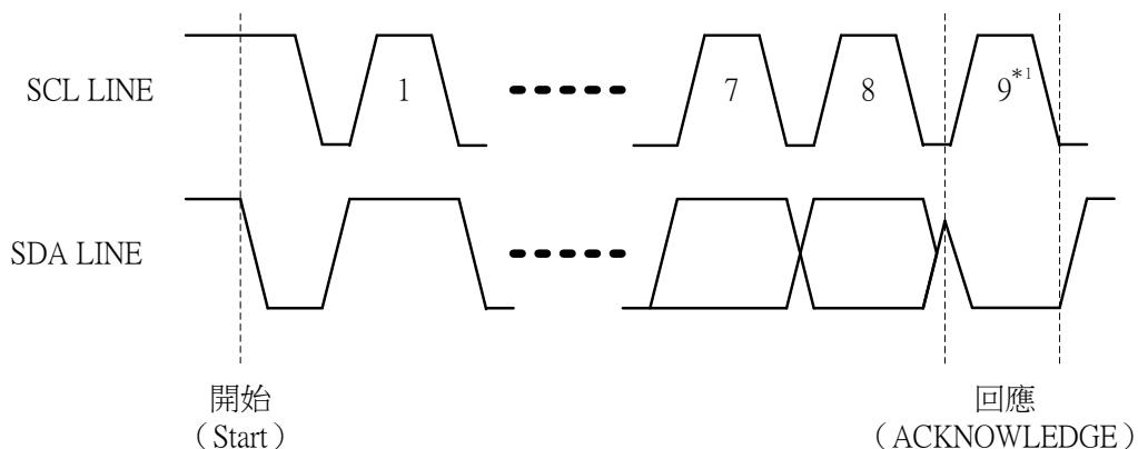
\*<sup>1</sup> 主控端 (Master) 向從機端 (Slave) 發送 SCL 信號的至第8個時鐘時，主控端的 SDA 引腳必須由輸出狀態轉為輸入狀態，以接收從機端產生的回應 (ACK) 信號。
