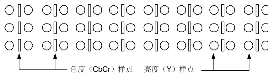
图6-19 YCbCr 4:2:2 interspersed 采样格式
