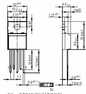
1) 1.<sub>0.15</sub> at dam bar (max 1.8 from body) 1) 1.<sub>0.15</sub> im Dichtstegbereich (max 1.8 vom Körper)
