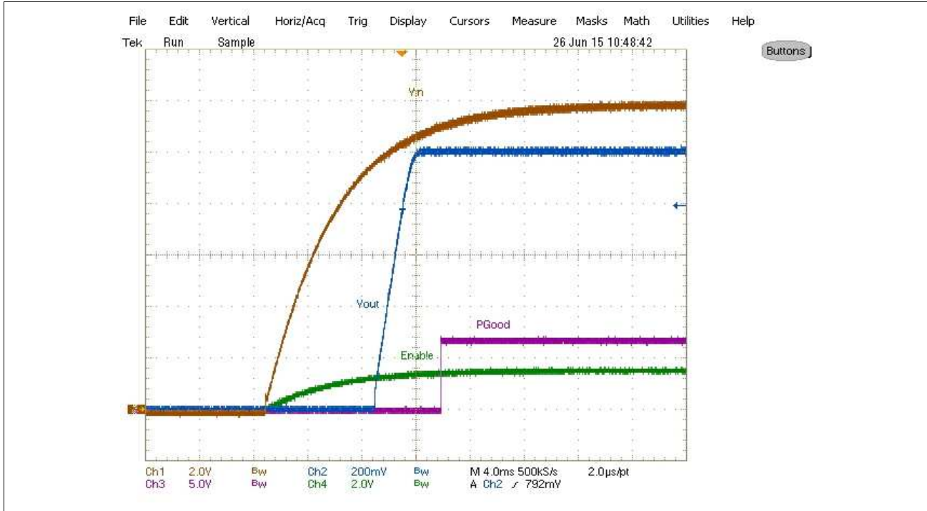
Figure 7-6 Startup at 20A Load (Ch 1 : V_{in} , Ch 2 : V_{out} , Ch 3 : PGood , Ch 4 : Enable )
