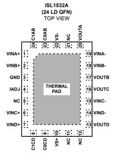
ISL1532A integrates 50k pull-up resistors on  $\ensuremath{\mathsf{C}_{\mathsf{O}}}$  and  $\ensuremath{\mathsf{C}_{\mathsf{1}}}$  pins.
