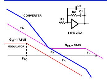
FIGURE 17. FEEDBACK LOOP COMPENSATION
