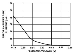
FIGURE 19. LINEAR CONTROLLER GAIN
