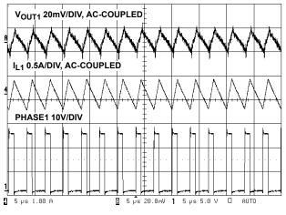
FIGURE 5. PWM1 WAVEFORMS
