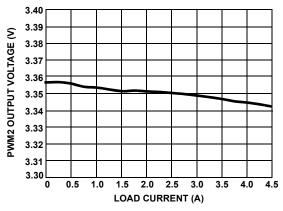
FIGURE 2. PWM2 LOAD REGULATION
