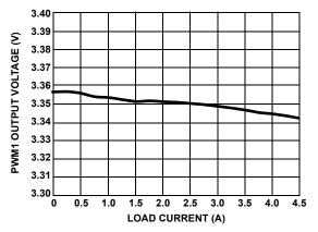
FIGURE 1. PWM1 LOAD REGULATION
