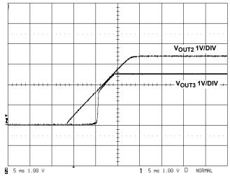
FIGURE 18. LINEAR REGULATOR START-UP WAVEFORM
