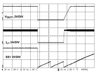
FIGURE 10. OVERCURRENT HICCUP MODE OPERATION
