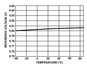
FIGURE 3. REFERENCE VOLTAGE VARIATION OVER TEMPERATURE
