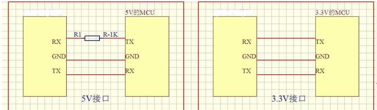
芯片的串口为 3.3V 的 TTL 电平，所以默认的接口的电平为 3.3V。如果系统是 5V。那么建议在串口的对接接口串联一个 1K 的电阻。这样足以满足一般的要求，如果应用于强电磁干扰的场合，请参考“注意事项”的说明。芯片在 5V 和 3.3V 的系统中均正常的测试过，一切正常。均在采用的是直连的方式，并没有串 1K 的电阻。
