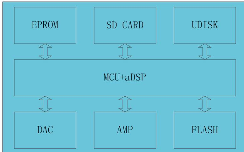
芯片选用的是 SOC 方案，集成了一个 16 位的 MCU，以及一个专门针对音频解码的 aDSP，采用硬解码的方式，更加保证了系统的稳定性和音质。小巧的封装尺寸更加满足嵌入其它产品的需求
