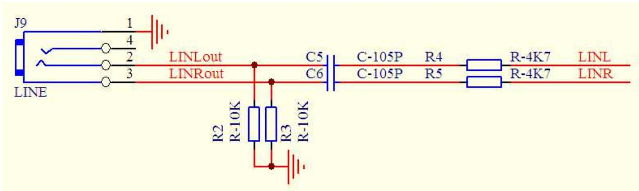
这里R4 和R5 为限幅电阻，防止外部音源幅度过大( $V_{p-p}$  最大值为3.0V)，影响系统的稳定性，C1 和C2 为隔直电容，防止外部音源的直流电平影响到芯片内部的偏置；R2 和R3 预留电阻给大功率设计用。
