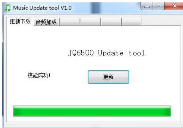
如图，则表示语音已经下载到模块的 spi flash 里了
