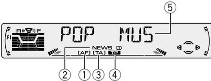
Das Radio-Datensystem (RDS) dient zur Übertragung spezieller Informationen in Kombination mit UKW-Programmen. Diese nicht hörbaren Informationen bieten Merkmale wie Programm-Service-Name, Programmtyp, Verkehrsdurchsage-Bereitschaft, und automatische Abstimmung, damit der Hörer gewünschte Sender schneller auffinden und abstimmen kann.
