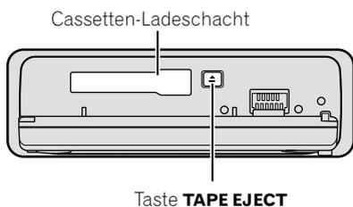
• Durch Drücken von **TAPE EJECT** wird die Cassette ausgeworfen.
