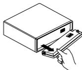
**3 Coloque el panel delantero en su caja protectora proveída para almacenamiento seguro.**
