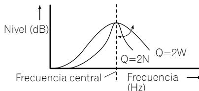
**1 Presione AUDIO y sostenga hasta que la frecuencia y el factor Q (por ej., F 80 Q 1W) aparezcan en la pantalla.**
