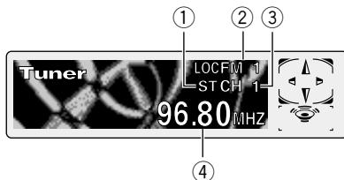
Estos son los pasos básicos necesarios para operar la radio. Operaciones más avanzadas del sintonizador se proveen desde la página 12. La función AF (búsqueda de frecuencias alternativas) de este producto se puede activar y desactivar. Se debe desactivar la función AF para la operación de sintonía normal (refiérase a la página 15).
