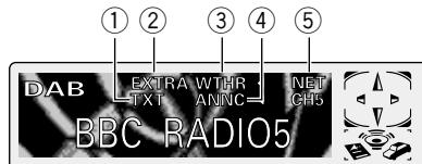
Se puede utilizar este producto con un sintonizador DAB oculto vendido separadamente (GEX-P700DAB). Para los detalles acerca de la operación, consulte el manual de instrucciones del sintonizador DAB (Este producto es una unidad principal del grupo 1.). Esta sección proporciona información sobre las operaciones DAB con este producto que difieren de los descritos en el manual de operación del sintonizador DAB.
