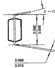
28 LEAD CERAMIC DUAL IN LINE PACKAGE
