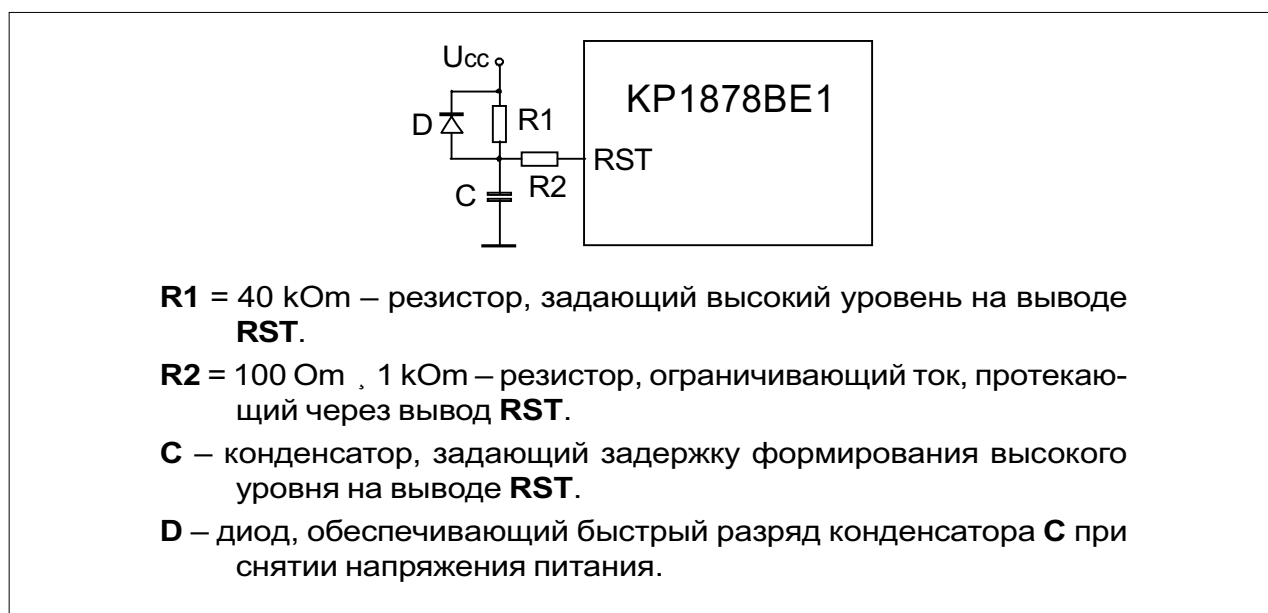
Рис. 15. Схема подключения для выработки сигнала RST
