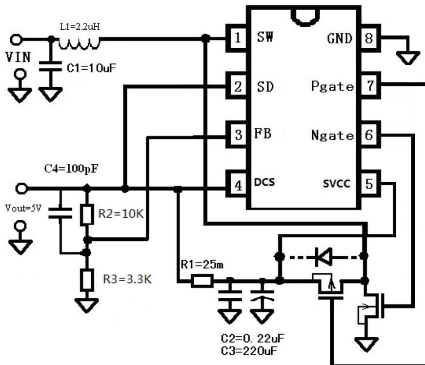
典型应用电路（恒压模式）B:  $V_{out}=5V$ 。
