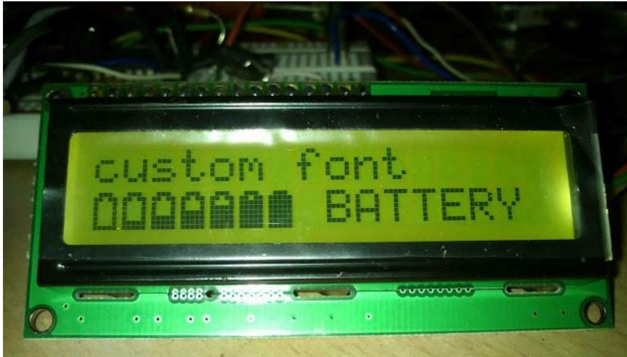
Beispiel für die Anwendung kundenspezifischer Symbole zur Batterie-Überwachung
