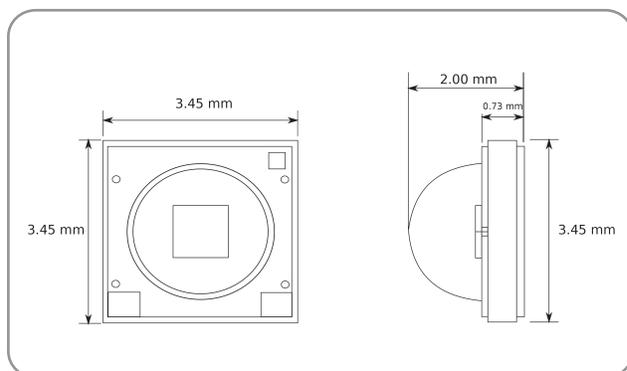
**Nota:** Es necesario dotar al LED de un disipador adecuado con el fin de mantenerlo dentro de la temperatura de operación especificada, de lo contrario una temperatura excesiva causará una degradación o daño permanente.
