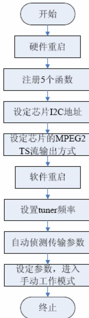
控制软件工作流程图
