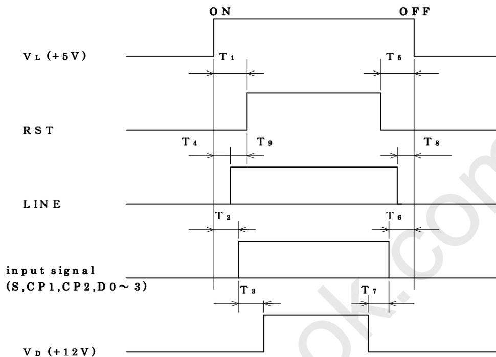
Note)  $8\text{ms} \leq T_1 \leq 50\text{ms}$ ,  $T_2 \sim 8 \geq 0$ ,  $T_9 \geq 8\text{ms}$  shall be kept.
