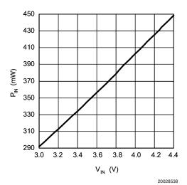
FIGURE 7.  $P_{\text{IN}}$  vs  $V_{\text{IN}}$  4 LEDs, 2.5  $\leq$   $V_{\text{DX}}$   $\leq$  3.9V,  $I_{\text{DX}}$  = 15mA
