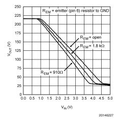
FIGURE 4.  $V_{\rm OUT}$  vs  $V_{\rm IN}$
