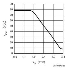
FIGURE 5. CRT Driver  $\rm V_{O}$  vs  $\rm V_{IN}$
