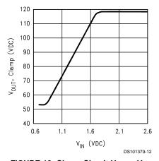
FIGURE 12. Clamp Circuit  $V_{\rm O}$  vs.  $V_{\rm IN}$
