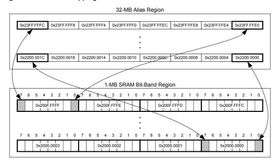
Figure 2-4. Bit-Band Mapping
