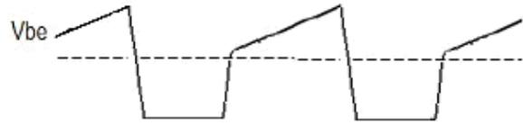
圖8：Vbe驅動電壓波形
