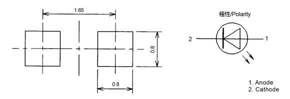
(注 1) パッケージ寸法については電極バリを含まない。 (Note1) Electrode projection is not included in the package dimensions.
