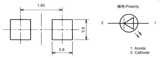
(注 1) パッケージ寸法については電極バリを含まない。 (Note1) Electrode projection is not included in the package dimensions.
