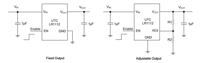
$$V_{OUT} = V_{REF} \left(1 + \frac{R1}{R2}\right)$$
