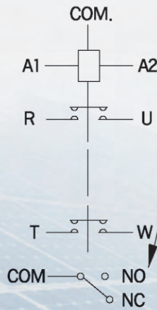
주접점 및 보조접점 배선도 CONNECTION DIAGRAMS
