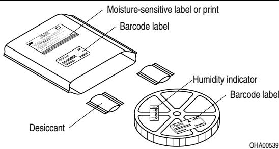
Anm.: Feuchteempfindliche Produkte sind verpackt in einem Trockenbeutel zusammen mit einem Trockenmittel und einer Feuchteindikatorkarte
