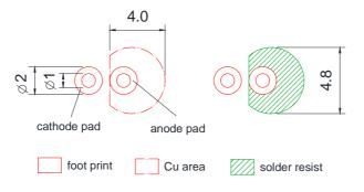
FIG.7 RECOMMENDED SOLDER PAD
