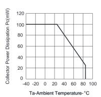
FIG.2 COLLECTOR POWER DISSIPATION VS AMBIENT TEMPERATURE
