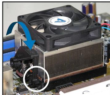
5. Wenn Kühlkörper und Lüfter installiert sind, verbinden Sie das CPU-Lüfterkabel mit dem CPU\_FAN-Anschluss auf dem Motherboard.
