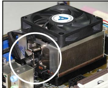
4. Drücken Sie den Hebel der Befestigungsklammer nach unten, um den Kühlkörper und Lüfter auf dem Modul zu installieren.
