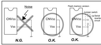
Fig. 90 Wiring for CNVss pin
