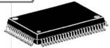
Outline 80P6N 0.8mm pitch QFP (20.0mm×14.0mm×2.8mm)
