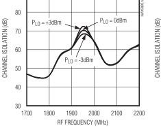
**CHANNEL ISOLATION vs. RF FREQUENCY**
