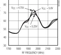
**CHANNEL ISOLATION vs. RF FREQUENCY**
