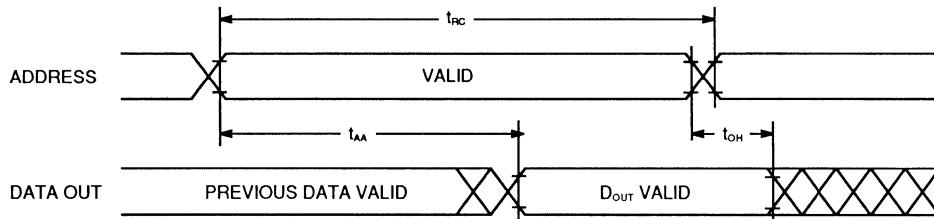
READ CYCLE :  $\overline{CS}_1$ ,  $CS_2$  CONTROLLED\*<sup>3</sup>
