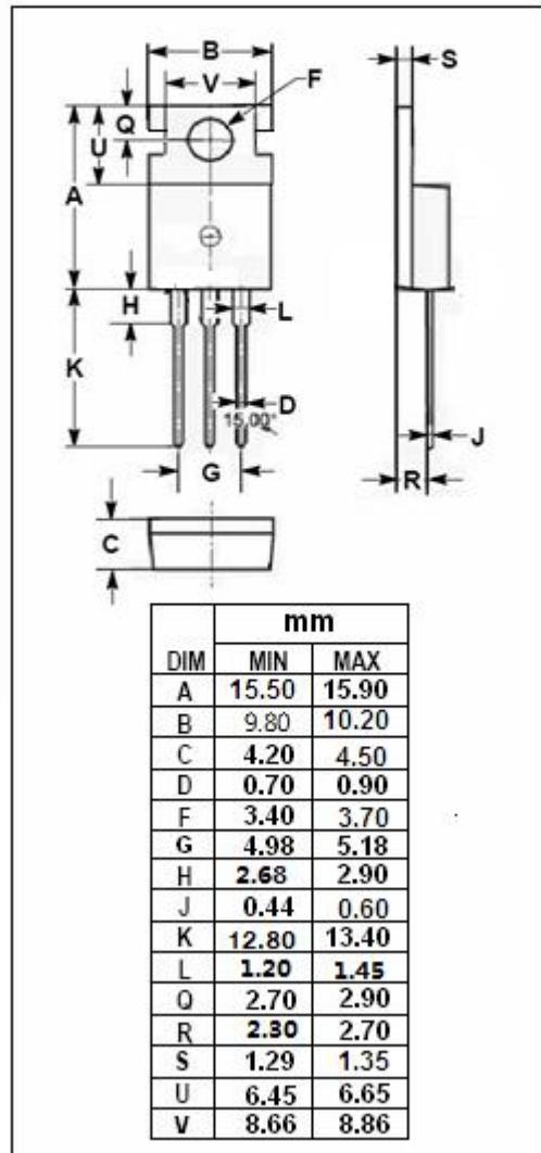
**Schottky Barrier Rectifier****MBR20H150CT****THERMAL CHARACTERISTICS**
