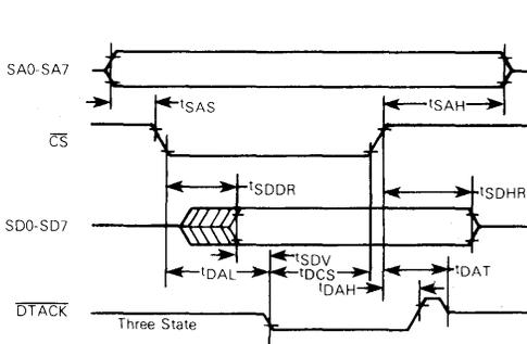
FIGURE 10 — ASYNCHRONOUS WRITE OF SEMAPHORE REGISTER
