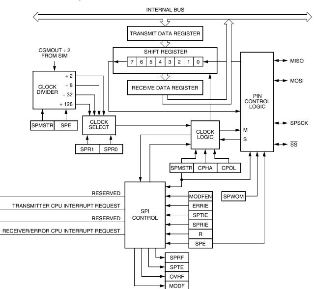
Figure 15-2. SPI Module Block Diagram
