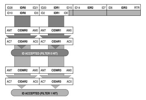
Figure 12-5. Dual 16-Bit Maskable Acceptance Filters
