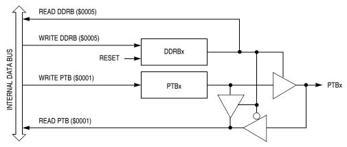
Figure 13-8. Port B I/O Circuit
