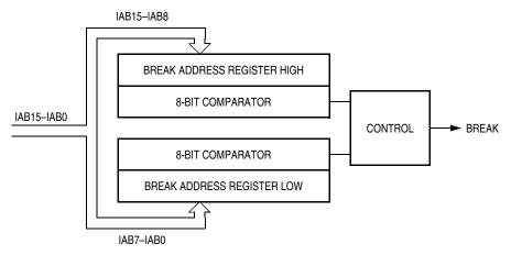
Figure 18-2. Break Module Block Diagram
