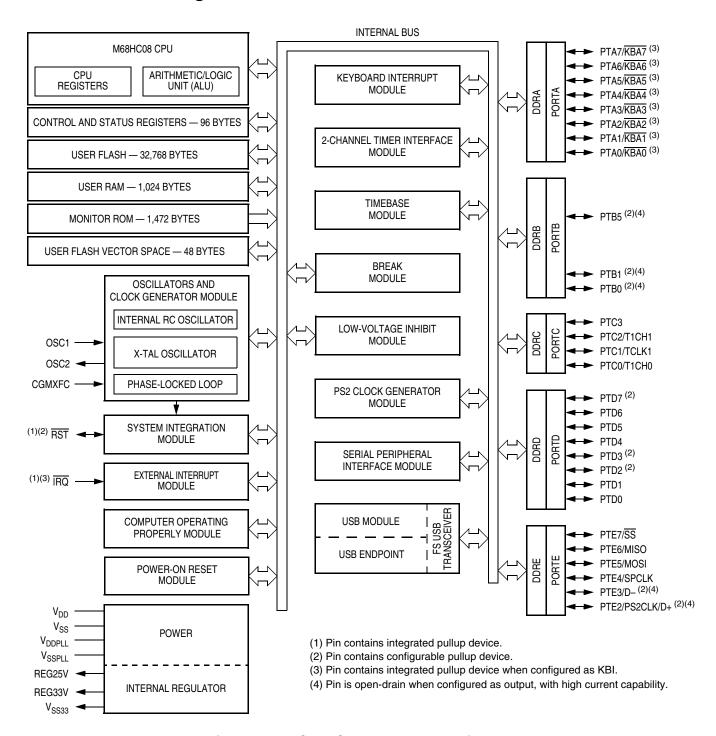
Figure 1-1. MC68HC908JW32 Block Diagram
