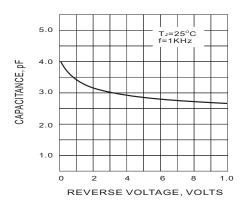
Fig.5 TYPICAL JUNCTION CAPACITANCE
