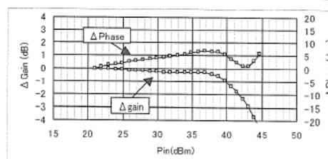
Test Condition : Vds=12V, Idq=2A, Ta=25deg.C
