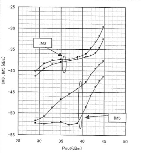
Test Condition : Vds=12V, Idq=2A, Ta=25deg.C
