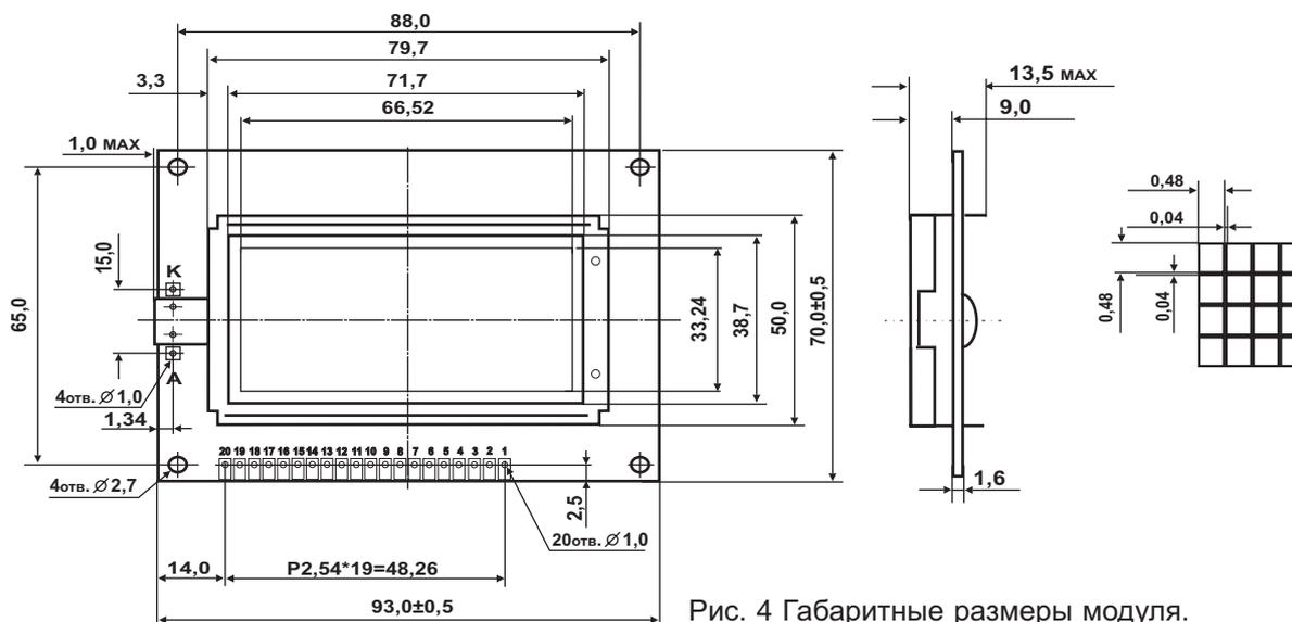
Рис. 4 Габаритные размеры модуля.
