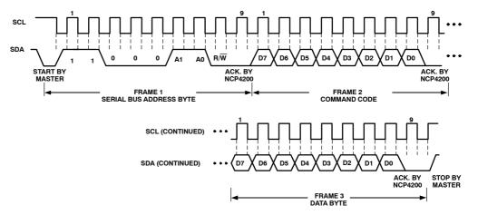
Figure 12. Write Byte
