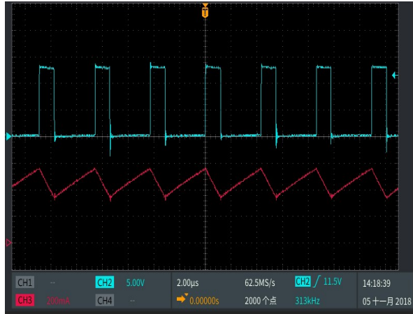
SW 脚与电感电流工作波形
